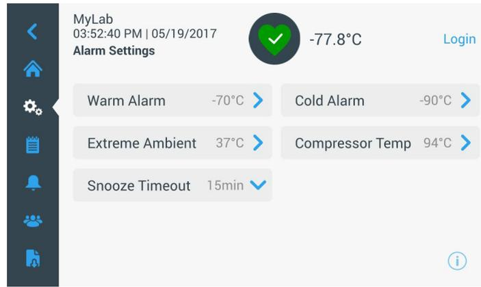
**Figura 31.** Pantalla Ajustes de alarma
