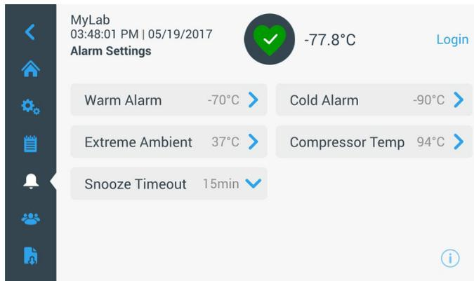
**Figura 52.** Pantalla Ajustes de alarma
